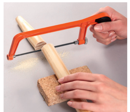
Holzklötz unterlegen und mit der Säge ca. 10 cm vom Besenstiel absägen.
